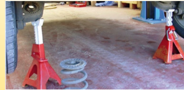
Das angehobene Fahrzeug absichern
