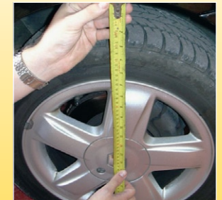
Messen Sie die Fahrzeughöhe von der Kotflügelkante bis zur Radnabenmitte
