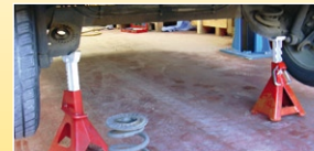
Das angehobene Fahrzeug absichern
